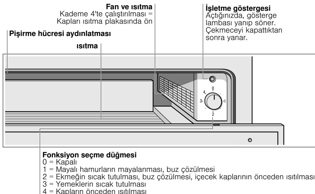
Cihaz ancak çekmece doğru olarak kapatıldığında ısıtır.
